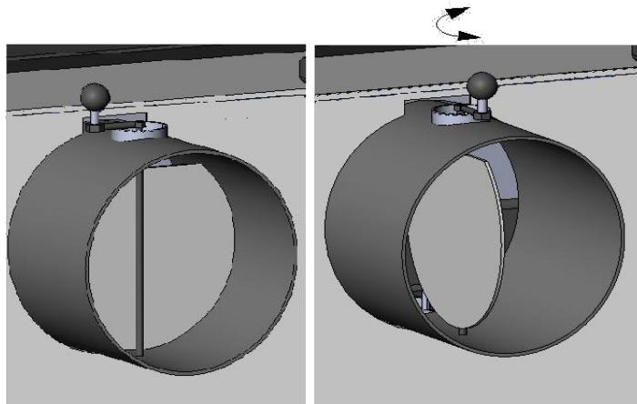
Для регулювання тяги на виході з димаря котла встановлена заслінка (мал.5)
